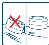
Un emplazamiento nivelado
