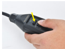
3. Drücken Sie die Test-Taste, die Anzeige erlischt.
